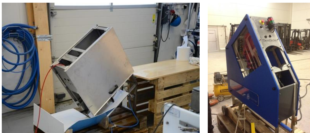
Figur 11 – Maskiner for bløgging av hvitfisk, Prototype 1 (til venstre) og Prototype 2 (til høyre).
