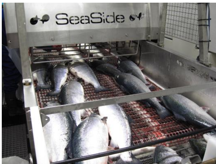
Figur 8 – SeaSide AS har tidligere utviklet en bløggerobot (Stansas # 15) for laks. Kan konseptet brukes på hvitfisk om bord på fartøy?
