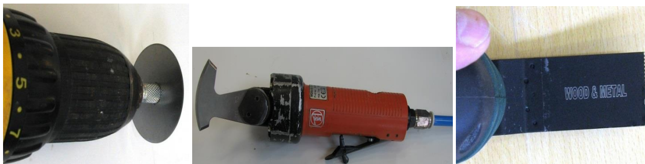
Figur 6 – Forskjellige verktøy med ulike knivtyper ble benyttet for å stikke eller skjære gjennom gjellelokk, samt for å lage strupekutt på torsk. Eksempelvis ser vi her en roterende kniv på venstre bilde, mens høyre bilde viser en oscillerende kniv.
