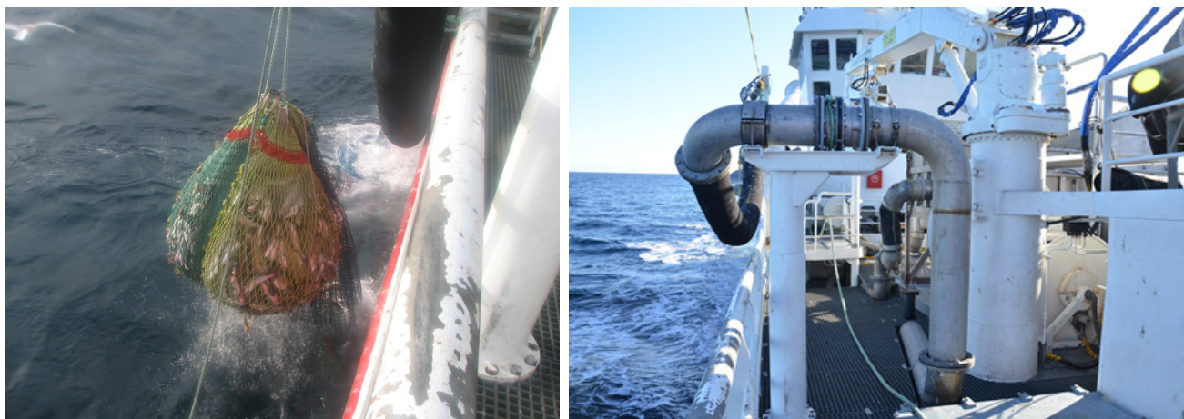
Figur 5. Bilder av ombordtaking ved sekking og pumping. Ombordtaking ved hjelp av sekking, ca 500 kg sløyd fisk pr sekk (venstre), MMC Tendos Fiskepumpe (høyre) (foto: SINTEF Fiskeri og havbruk)
