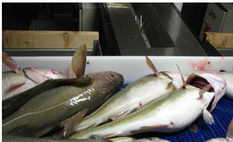
Bilde 3-2; Elektrobedøvd fisk. Merk torsk med åpne gjellelokk rett etter elektrobedøving. Foto: SINTEF Fiskeri og havbruk.
