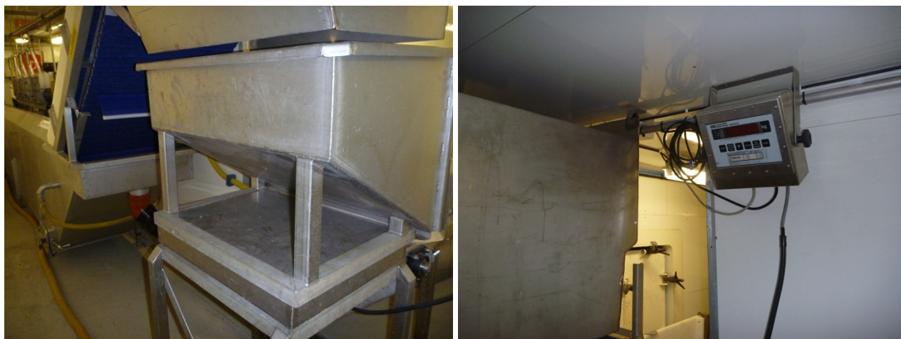
Bilde 2-4; Vekt og display for on-line batchveiling av fangst. Foto: SINTEF Fiskeri og havbruk AS
