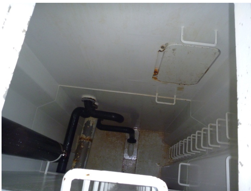
Bilde 2-10; Tom levendefisktank på 60 m 3 , sett fra toppluka. Foto: SINTEF Fiskeri og havbruk AS
