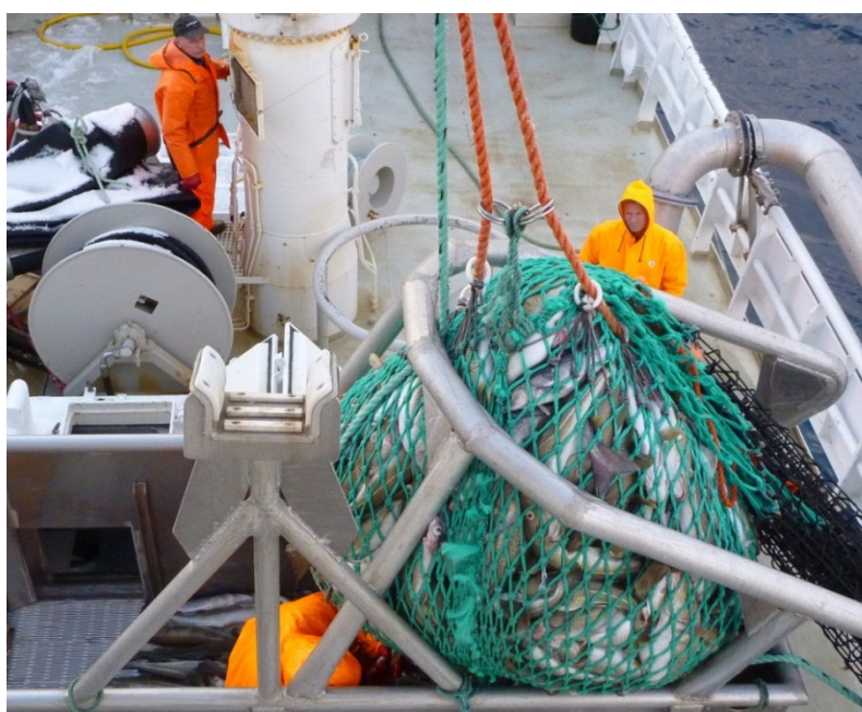
Bilde 2-7; Sekking, like før tømming av sekk fra snurrevadfangst. Foto: SINTEF Fiskeri og havbruk AS
