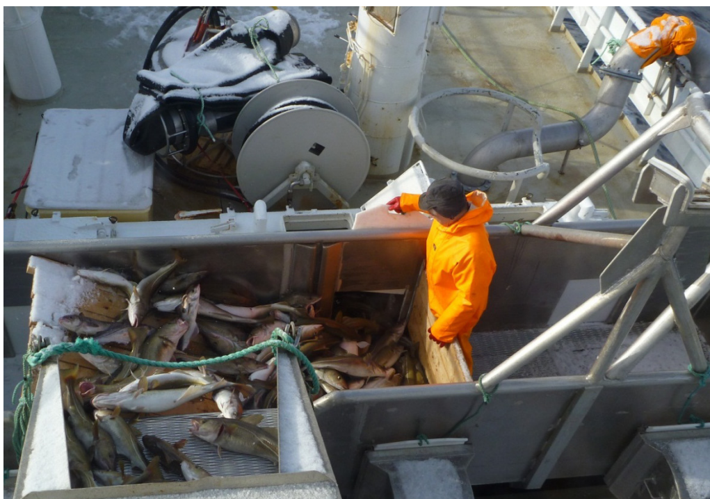
Bilde 2-8; Ombordtaking ved pumping. Fisken kommer ut over silkassen hvor den blir grovsortert. Foto: SINTEF Fiskeri og havbruk AS
