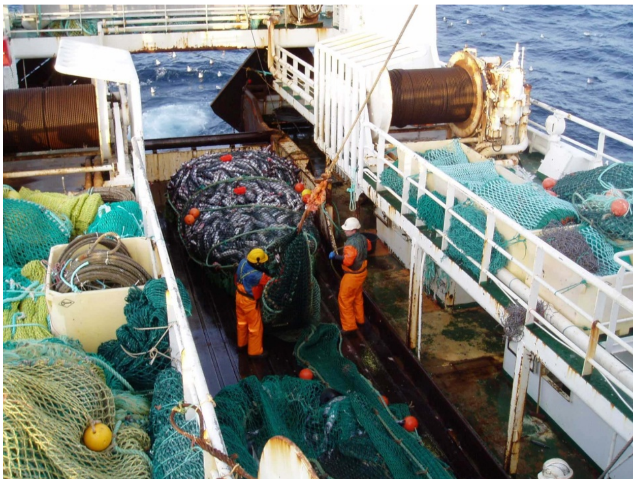
Bilde 3 Inntak av trålsekk inn på tråldekket for tømning av fangst ned til fabrikkdekk .
